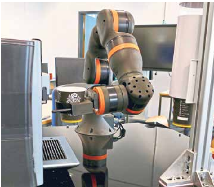
Entwicklung eines Studierenden: der einarmige Roboterarm, der ohne Schutzzaun nutzbar ist. Er hält automatisch an, wenn er auf einen Widerstand trifft.
